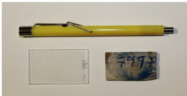
Abb. 2: Dünnschliff der zu untersuchenden Gesteinsprobe. (Magnetstift = 12,5 cm)
